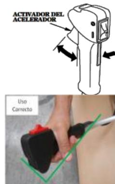
El gatillo del acelerador controla la velocidad del motor
