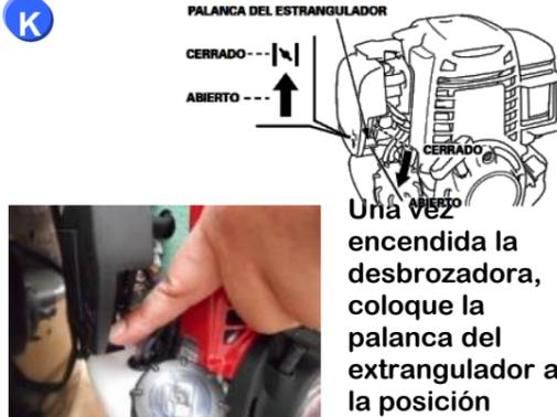
Una vez encendida la desbrozadora, coloque la palanca del estrangulador a la posición ABIERTO
