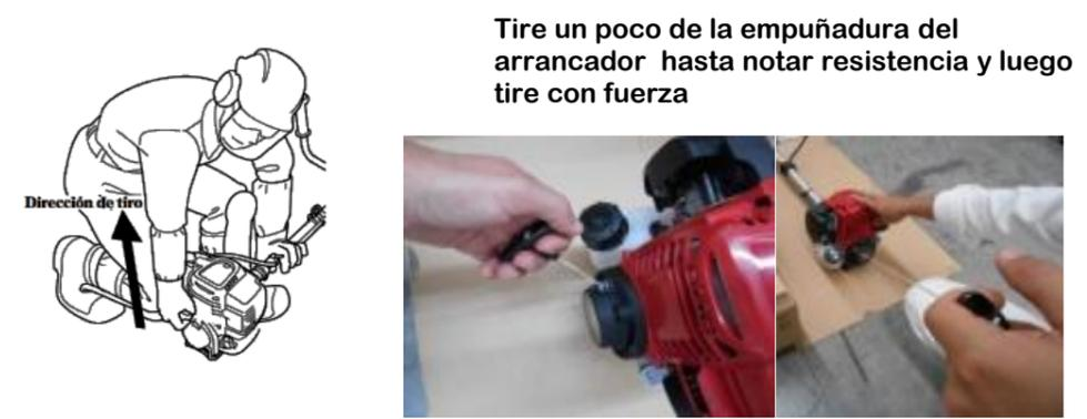
Tire un poco de la empuñadura del arrancador hasta notar resistencia y luego tire con fuerza
