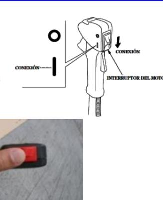
Coloque el interruptor de encendido a la posición ON
