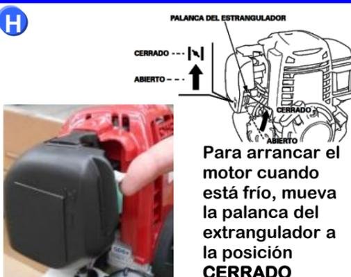
Para arrancar el motor cuando está frío, mueva la palanca del estrangulador a la posición CERRADO
