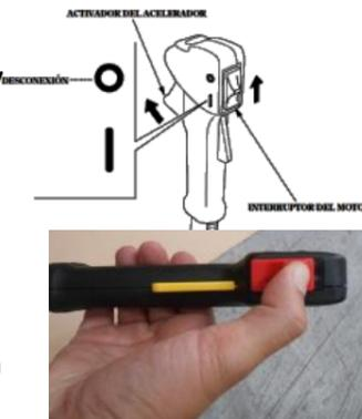
Libere el acelerador y Coloque la palanca del acelerador en la posición lento. Ponga el interruptor del motor en la posición apagado
