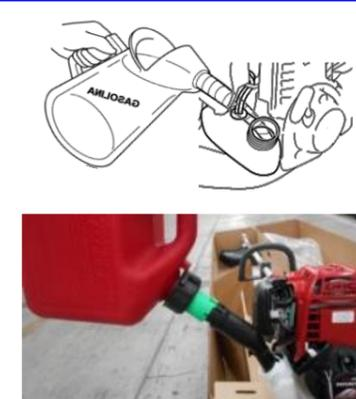
Coloque Gasolina nueva al tanque sin exceder el cuello del tanque a fin de que esta no se derrame
